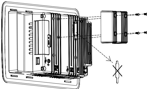
4. Befestigen Sie das Erweiterungsmodul mithilfe der beiliegenden Schrauben an seiner Montageposition.
